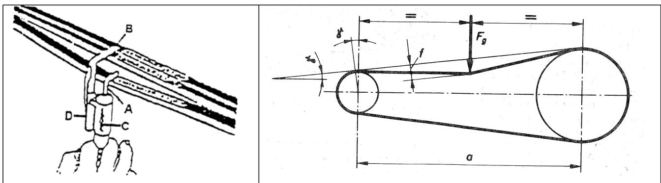
Die Prüfung der notwendigen Riemenspannkraft führt man auf der Grundlage der Belastungskraft  $F_g$  verursachter Riemendurchbiegung durch. Um die Durchbiegung zu messen hängen man die Messvorrichtung mit dem Lastgewicht auf der Mittelpunkt A des Riemenantriebes auf. Den Zeigefinger auf die Null stellen. Die Prüfkraft nach der C-Skala anwenden. Um das zu machen muss
