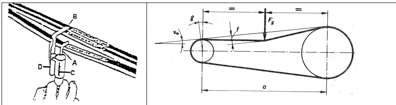
Provjera ostvarene sile zatezanja remena vrši se na osnovu njegovog progiba izazvanog silom  $F_g$ . Kako bi izmjerili progib pozicionirajte mjernu skalu s opteretivom kukom A u centar remenske staze. Postavite vučni pokazivač na nulu. Primijenite ispitnu silu u skladu sa skalom C. Za ovo, povucite mjernu skalu pod kutom od 90 stupnjeva od remenske staze. Pročitajte dubinu utiska na skali D vučnog pokazivača.
