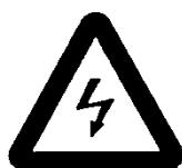
Gefahr durch elektrischen Strom oder hohe Spannung!
