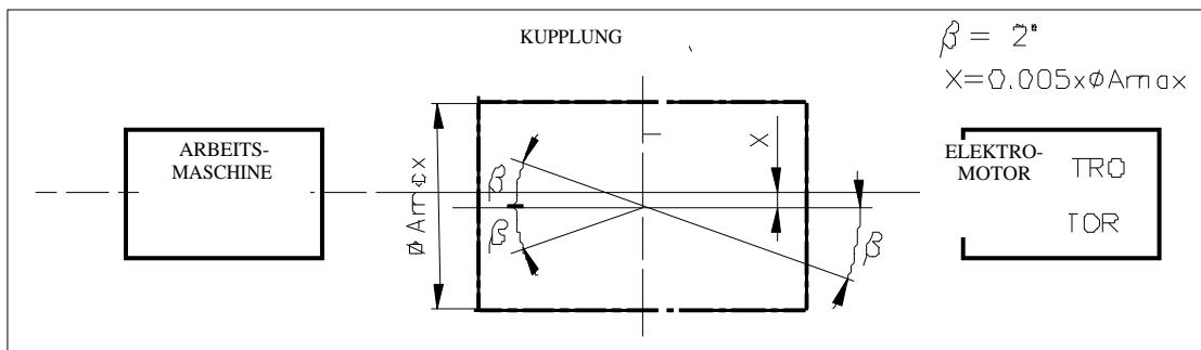
Die Rotorwellen sind dynamisch nach ISO 8821 mit halbem Keil ausgewuchtet und deswegen sollen auch andere Elemente welche direkt auf die Antriebswelle des Motors montiert sind, gleichartig dynamisch ausgewuchtet sein.
