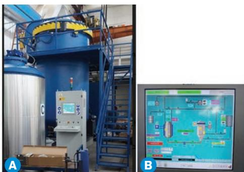
Slika 3: Novo postrojenje za vakuum tlačnu impregnaciju (VPI) smolom s nanočesticama (A) i upravljanje procesom impregnacije (B)
