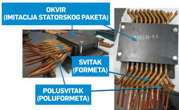
Slika 5: Formete uložene u okvire i pripremljene za ispitivanje izolacijskog sustava prema IEC normama
