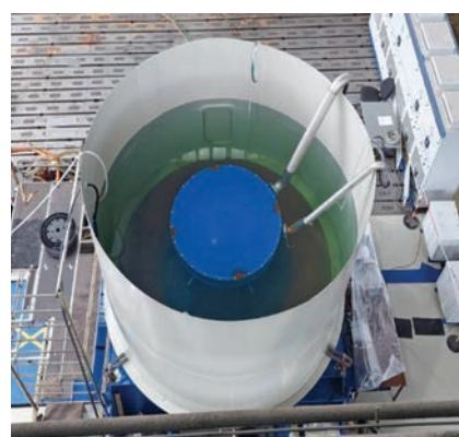
Slika 6: Ispitivanje generatora potopljenog u kadi s vodom i pogonjenog asinkronim motorom koji su spojeni na frekvencijski pretvarač u *back-to-back* spoju u ispitnoj stanici
