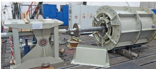
Slika 2: Naprava za magnetiziranje rotora uz njegovo aksijalno i radijalno pomicanje, a u pozadini se vidi elektronički uređaj za impulsno magnetiziranje strujom do 30 kA
