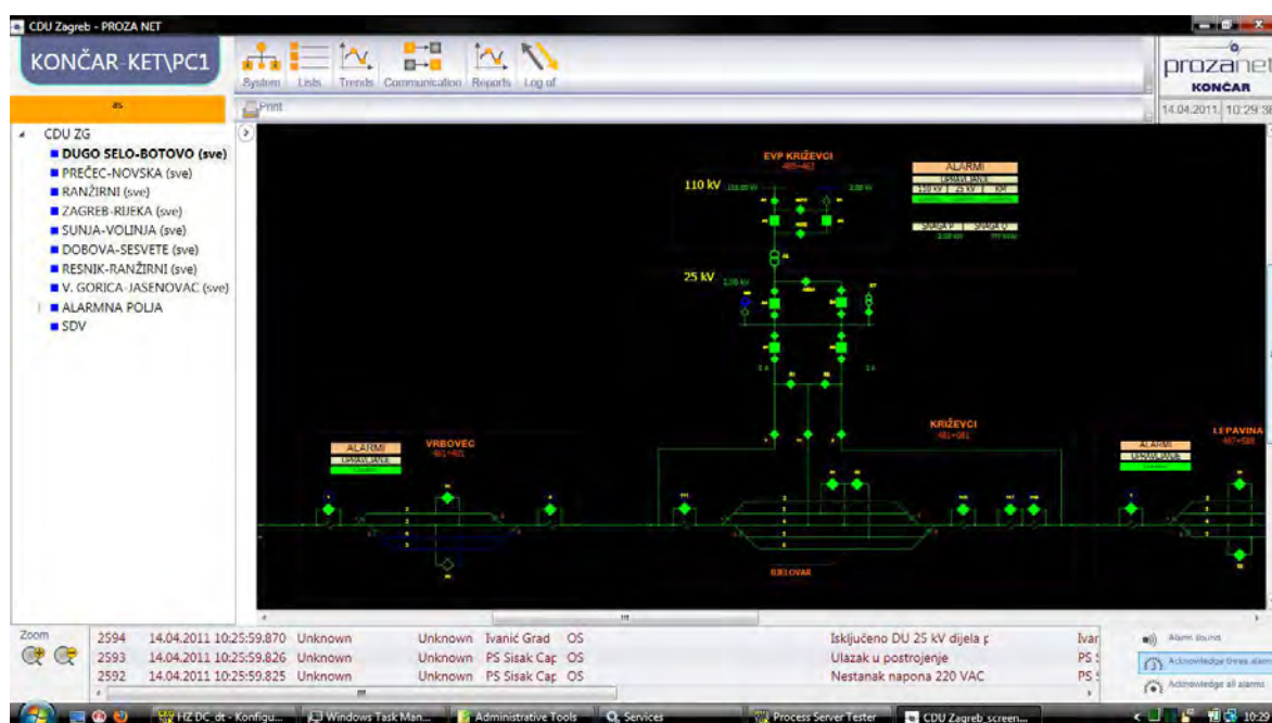
SCADA za daljinsko upravljanje
